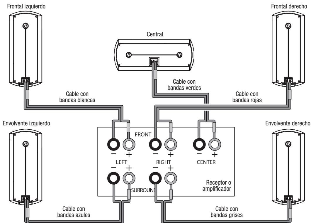
**IMPORTANTE:** Compruebe que la parte pelada de los cables (+) y (-) no entren en contacto entre sí o tocan el otro terminal. Producirían un cortocircuito que puede dañar el amplificador o el receptor.
