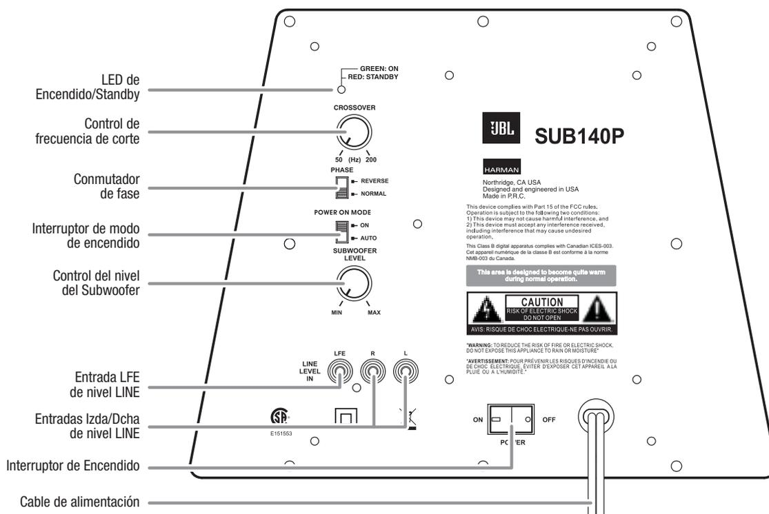
**LED de Encendido/Standby:** Cuando el interruptor de modo de encendido está en la posición “Auto”, la luz LED indica si el subwoofer está encendido o en modo en espera (Standby):
